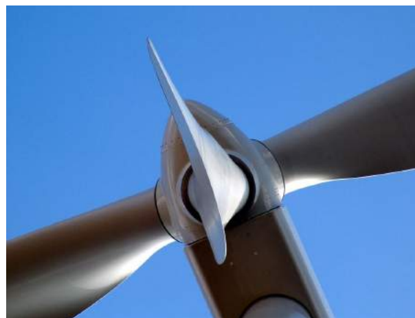
Photo 20 : Annulation de la portance des pales d'éolienne par "mise en drapeau" (Source : Larousse.fr)
