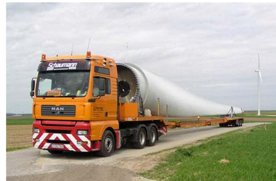
Photo 8 : Exemple de transport de pale par convoi exceptionnel (Source : SENVION)
