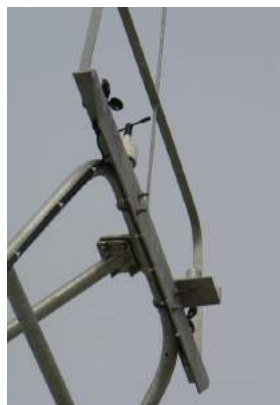
Photo 7 : Exemple d'anémomètre et girouette sur nacelle (Source : The Wind Power)
