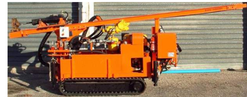
Photo 13 : Sondage de type wagon drill hydraulique (Source : FONDASOL)
